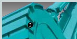
② 肉厚の耐摩耗鋼板を側板に新規採用し、側面の変形を防止。
